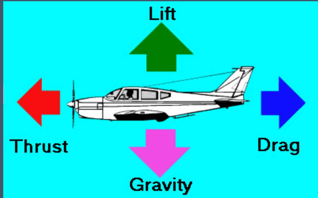
عندما يكون الوزن و الرفع في اتجاهين معاكسين و متساويين، تكون الطائرة في حالة توازن في الهواء؛ فلا تطفو (ترتفع) ولا تغرق (تنخفض). وعندما يكون الرفع والمقاومة في اتجاهين معاكسين و متساويين تكون الطائرة في حالة سرعة ثابتة.
